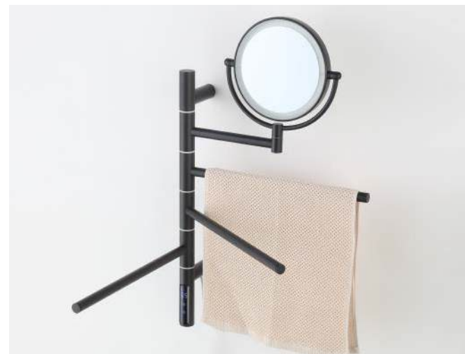
DR3050 亮光 Polished DR3050-B 黑色 Black DR3050-GYD 枪灰 Gray 电热毛巾架 Heated towel rail 规格/Size: 41.1x11x67.2cm 材质/Material: 304# 不锈钢 304# stainless steel 电压/Voltage: 220-240V 频率/Rated Frequency: 50-60Hz 功率/Power: 33W 温度/Temperature: 45°C, 50°C, 55°C IP防水等级/ IP Rating: IPX4
